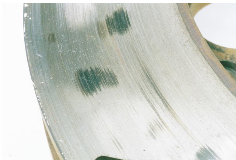
Obr. 4 – nepravidelné nánosy materiálu destiček na kotouči
