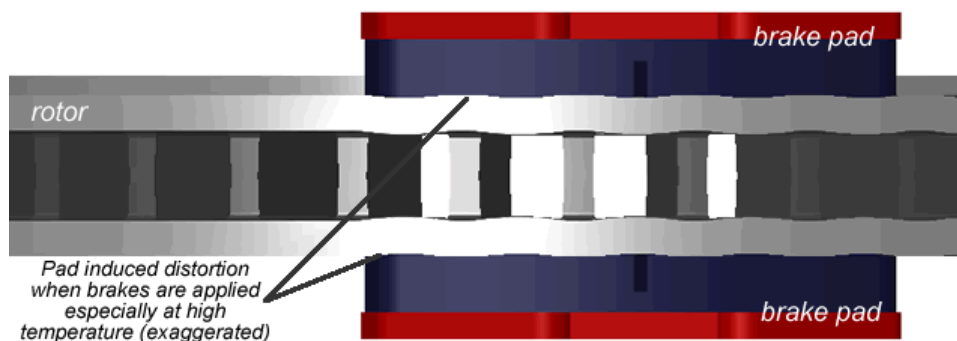
Obr. 3 – propadlé brzdné plochy
